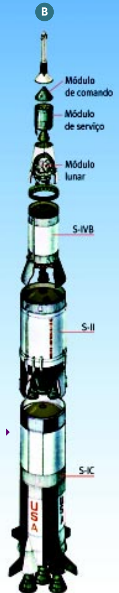
Figura 1. Em A, lançamento da Apollo 11, em 16 de julho de 1969, a bordo do foguete Saturno V, o mais poderoso veículo lançador espacial já construído pela humanidade. Em B, configuração de lançamento do foguete Saturno V para uma missão Apollo à Lua. Observe que o foguete propriamente dito se constitui de três módulos: S-IC, S-II e S-IVB. A nave Apollo, constituída dos módulos de comando e serviço, se acopla ao Saturno V acima da estrutura de armazenamento do módulo lunar
